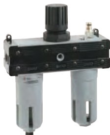
T200 F+R+L - semi-automatische aftap - 20 µm - 0-8 bar
