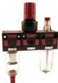
Serie 042 - F+R+L - 1/4" - modulair - 20µm - compacte transparante bowl
